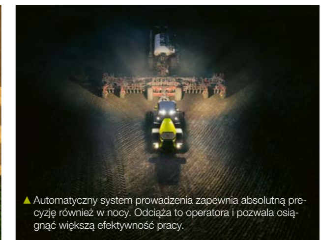
▲ AXION 800 – uprawa gleby. Wyposażenie cyfrowe: GPS PILOT CEMIS 1200 w trybie konturu A-B i CEMOS.
